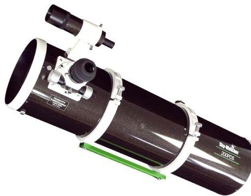
Exemplo de telescópio reflector newton, Skywatcher 200 PDS, com 200 mm de abertura, 1000 mm de distância focal, f/5. O preço deste telescópio anda por volta dos 400€. Repare que para um preço semelhante, este telescópio tem uma abertura três vezes maior comparativamente com o exemplo do telescópio refractor anterior. Créditos: Skywatcher.
