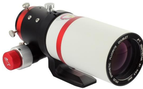
Exemplo de telescópio refractor apocromático, William Zenithstar 61 Apo, com 61 mm de abertura, 360 mm de distância focal, f/5.9. O preço deste telescópio anda por volta de 450€. Créditos: William Optics.
