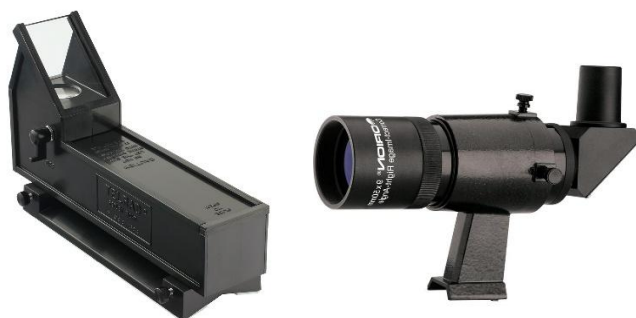
Figura 11: exemplos de diferentes tipos de buscadores. Da esquerda para a direita: buscador tipo ponto vermelho - Telrad red dot; buscador tipo luneta - Orion 9x50. O buscador tipo luneta apresentado tem um prisma na extremidade, que redirecciona a imagem e assim permite um maior conforto visual na observação. Pessoalmente prefiro usar o buscador sem o prisma, de modo a ter uma melhor precisão ao apontar o telescópio. Outros astrónomos preferem utilizar o prisma. Créditos: Telrad | wwwcompany7.com ; Orion | www.telescope.com
